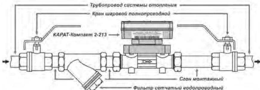
**Рисунок 13** – Пример монтажа теплосчетчика в трубопровод
