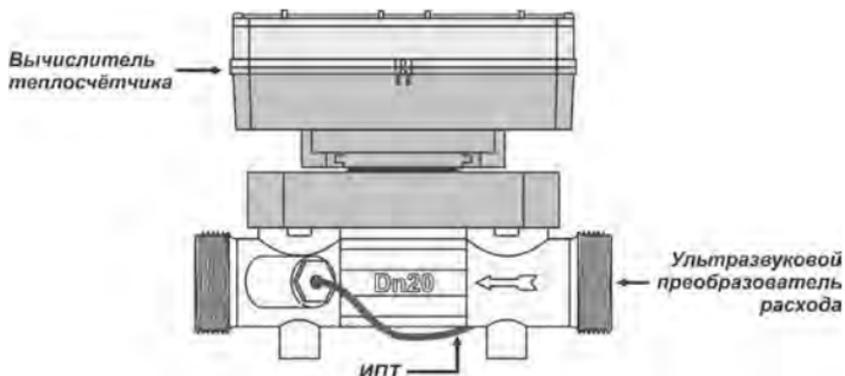
**Рисунок 4** – Теплосчетчики KAPAT-Компакт 2-213
