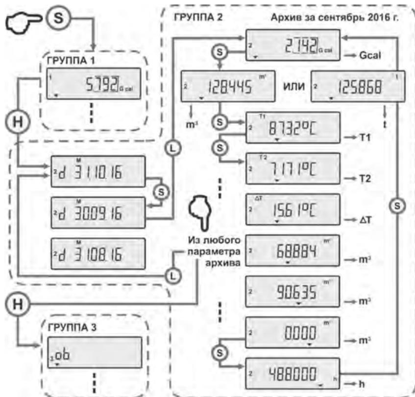
Рисунок 9 – ГРУППА 2 – архив теплосчетчика
