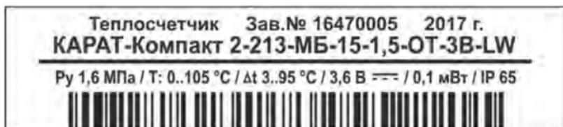
*Рисунок 6 – Пример маркировки теплосчетчика*
