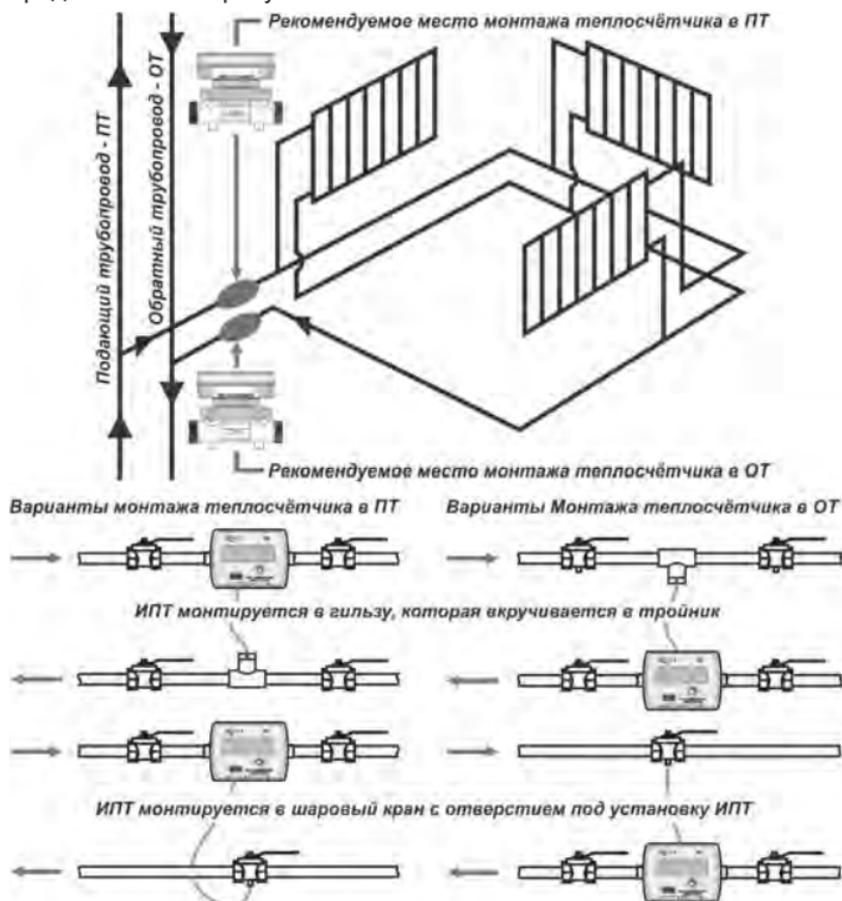
**Рисунок 11** – Рекомендуемые схемы монтажа в трубопровод
