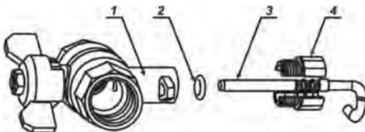
1 – шаровой кран с отверстием под установку термометра сопротивления; 2 – кольцо уплотнительное; 3 – измерительный преобразователь температуры; 4 – адаптер
