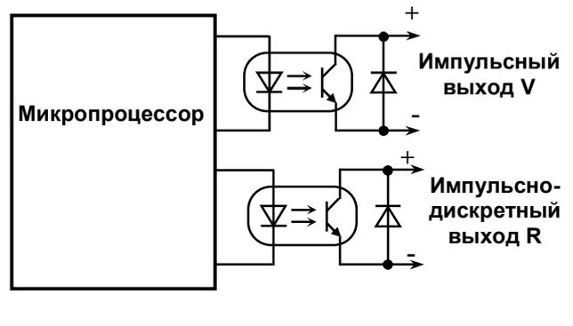
**Рисунок 3.5 - Организация выходов преобразователей модификации МФ исполнения Р**
