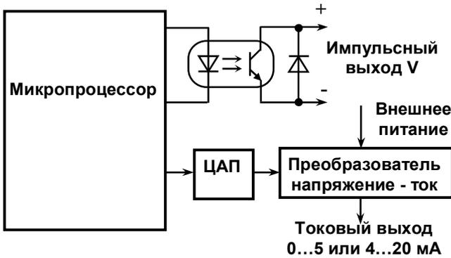
**Рисунок 3.4 - Организация выходов преобразователей модификации МФ-Т**
