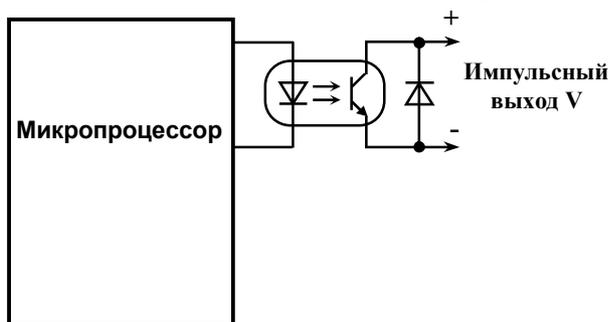
**Рисунок 3.2 - Организация выхода преобразователей модификации МФ**
