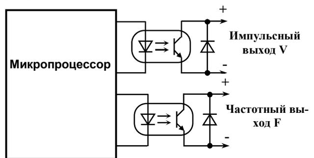
**Рисунок 3.3 - Организация выходов преобразователей модификации МФ-Ч**
