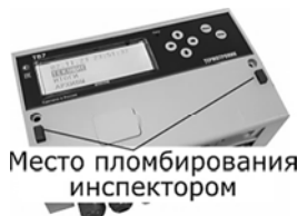
б) Пломба инспектора снабжающей организации
