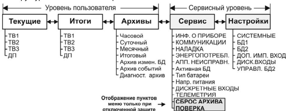
Рис. 2.5 – Структура меню тепловычислителя
