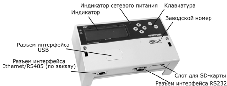
Рис. 2.1 – Внешний вид приборного отсека ТВ7 (вид сверху)
