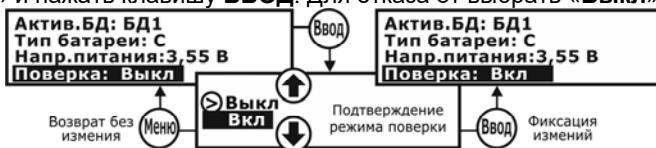
Рис. 3.14 – Включение режима поверки
